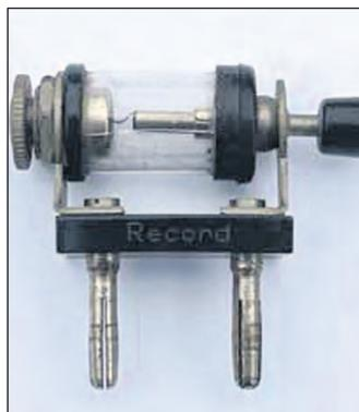
Kristall-Detektor. Der Radioempfang gelang nur, insofern der Sender mittels einer sehr feinen Nadel eine bestimmte Stelle auf einem Kristallsplitter (Pyrit, Bleiglanz oder ähnliches) traf.
